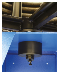
REEL ROLLER MECHANICAL BRAKE 机械式刹车装置
