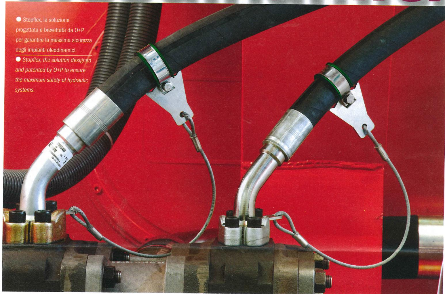
L'offerta O+P nel campo delle attrezzature per impianti oleodinamici include Stopflex, una soluzione per il trattenimento dei tubi in pressione in grado di garantire la massima sicurezza dell'impianto, e l'unità mobile multifunzionale Center Maxi, un vero e proprio centro di lavoro attrezzato per la preparazione del tubo rigido.
